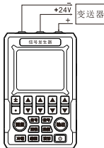
图 6 测量三线制变送器
