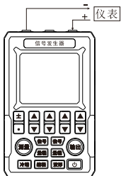
图 4 测量电压，有源电流信号
